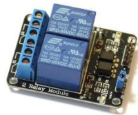
รูปภาพที่ 5 แสดง Relay Module ที่ใช้ควบคุมอุปกรณ์ไฟฟ้า
