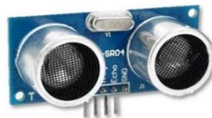
รูปภาพที่ 4 แสดง Ultrasonic Sensor Module สำหรับตรวจสอบระยะทาง
