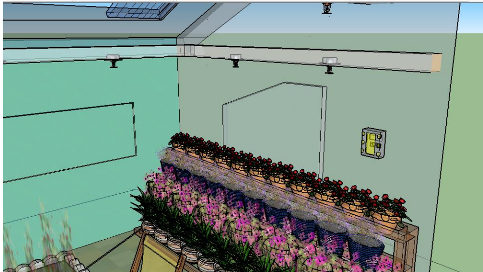
ภาพที่ 17 ผลการออกแบบภายในโรงเรือนของโมดูลการรดน้ำโดยใช้ปั้มน้ำ
