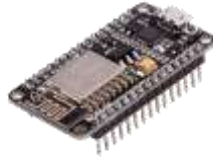
รูปที่ 3 อุปกรณ์ไมโครคอนโทรลเลอร์ NodeMCU ESP8266 (จิรวินัญ ดีเจริญชีพวงศ์, 2562)
