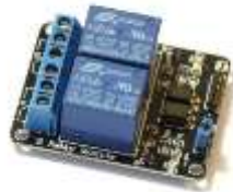
รูปที่ 4 Relay Module ที่ใช้ควบคุมอุปกรณ์ไฟฟ้า (จิรวินัญ ดีเจริญชีพวงศ์, 2562)
