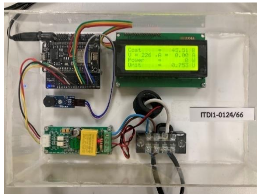
ภาพประกอบ 6 แสดงอุปกรณ์ระบบคำนวณค่าไฟภายในบ้านผ่าน Application
